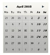
これがサブフォームに挿入されると、DatePickerオブジェクトは**バインド変数**により提供されるメカニズムのおかげで、プログラミングを行うことなく利用することができます。 つまり、 サブフォームオブジェクトにバインドされた変数 (プロパティリストの"変数名"プロパティ) の値を使用して表示と入力を管理することができます。
