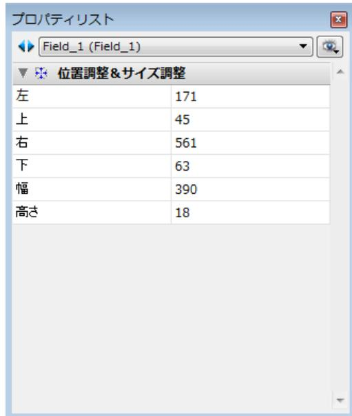
上記の場合"位置調整&サイズ調整"プロパティがロック解除されているため、ユーザーはオブジェクトを移動したり大きさを変更したりできます。
