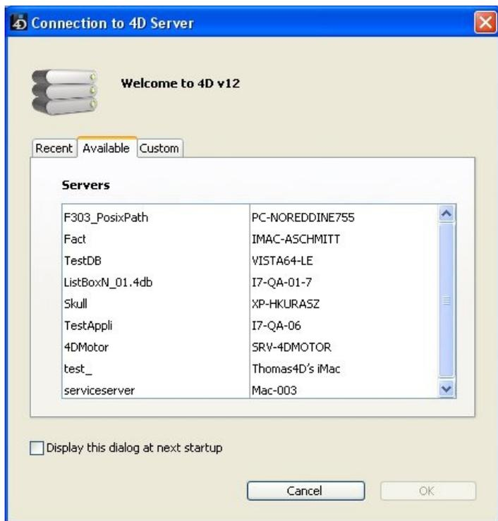
4D Serverには組み込みのTCP/IPブロードキャストシステムがあり、デフォルトで、ネットワーク上に利用可能な4D Server データベースの名前を公開します。この名前は接続ダイアログボックスの**利用可**ページに表示されます。
