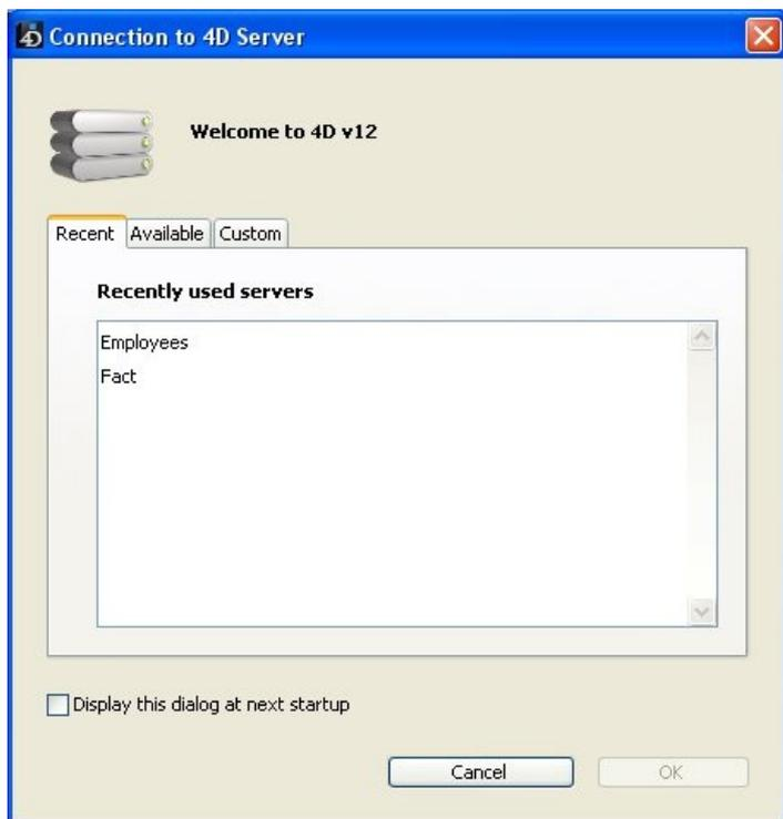
最近使用したサーバページは、最近使用した4D Serverデータベースを記憶しています。リストは名前順でソートされます。このリストからサーバに接続するには、名前上でダブルクリックするか、名前を選択して**OK** ボタンをクリックします。
