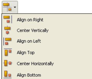
4D がオブジェクトを揃える場合、選択オブジェクトのうち1 つを定位置に置いたまま、残りのオブジェクトをそのオブジェクトに整列させます。この1 つのオブジェクトが“アンカー (基準オブジェクト)”となります。整列を行う方向で最も離れた位置にあるオブジェクトがアンカーとして使用され、他のオブジェクトはこのオブジェクトに合わせられます。例えば、一連のオブジェクトに対して右揃えを実行したい場合、一番右側に位置するオブジェクトがアンカーとして使用されます。
