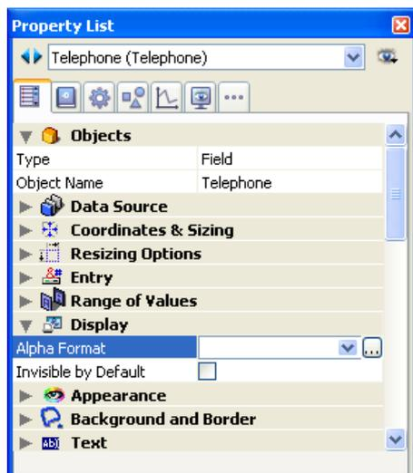
コンボボックスを使用して表示フォーマットを表示・選択したり、直接入力したりできます。[...]ボタンをクリックするとフィルター設定ウィンドウが開きます（[フィルターエディター](#)参照）。
