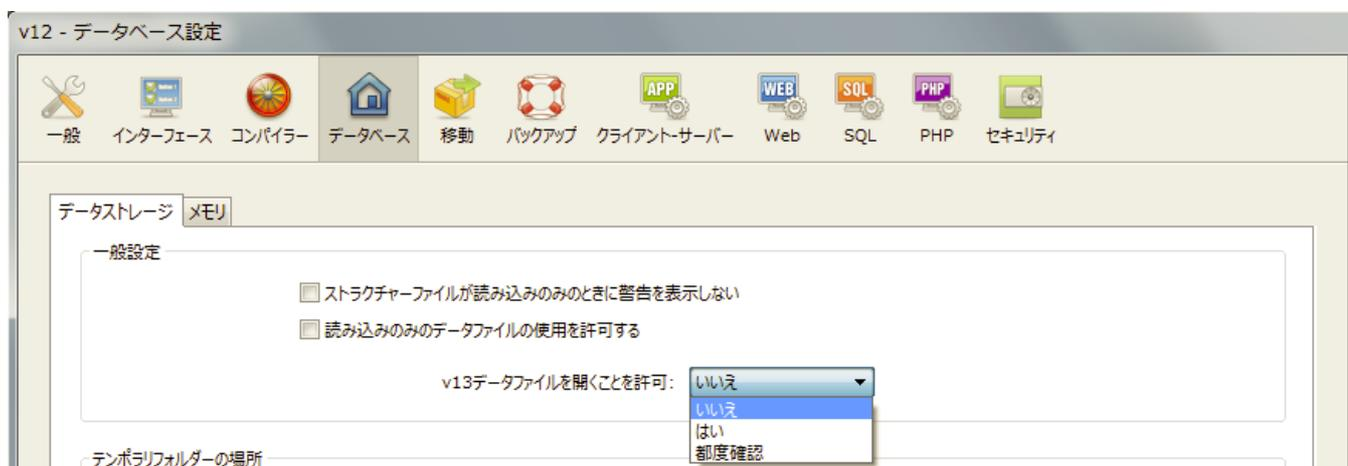
デフォルトでは**いいえ**オプションが選択されています。**はい**を選択すればデータファイルが直接開かれ、**都度確認**を選択するとデータを開く前に確認ダイアログが表示されます。
