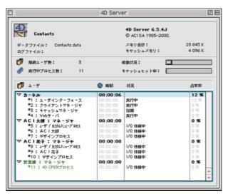
4D Serverのウィンドウには、クライアントマシン名、ユーザ名、プロセス名がクライアントごとに階層化されて表示されます。ここで表示される情報はOP Open connectionルーチンを使って指定します。
