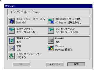
メインのオプションウインドウには9個のアイコンがあり、それぞれが選択または解除されるオプションを表わしています。コンパイルするデータベースに応じて、これらのオプションのいくつか、あるいはすべてを使用することができます。アイコンをクリックして、動作の一つを選択します。2回目にクリックすると、最初の設定をキャンセルします。設定に応じてアイコンの表示が変化します。
